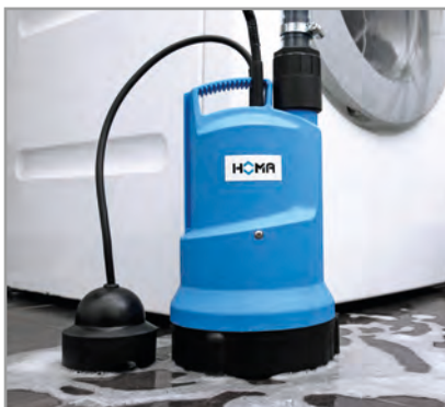
C240 WF: Automatische Einschaltung ab einem Wasserstand von 5 mm - Restabsaugung bis auf 2 mm.
