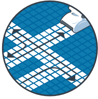
Abtasten des gesamte Schwimmbads
